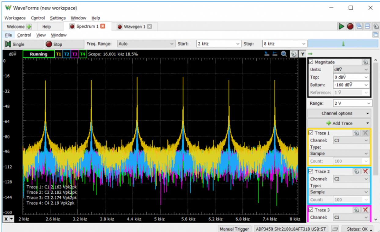
Analog Discovery Pro (ADP3450 / ADP3250) 可以与 WaveForms 的“频谱”仪器一起使用，以查看在模拟输入通道上捕获的模拟信号的频域分量的功率。
