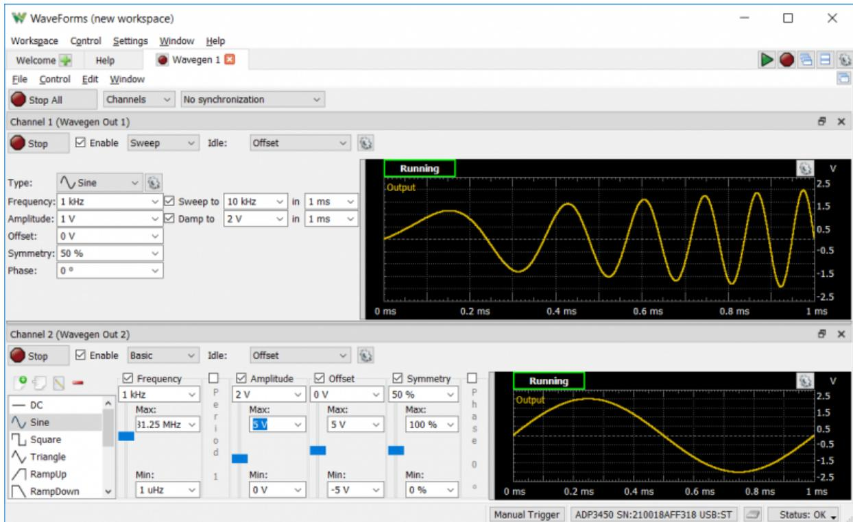
Analog Discovery Pro (ADP3450 / ADP3250) 可以与 WaveForms 的波形发生器仪器一起使用，以通过 BNC 电缆输出模拟电压波。波形发生器在两个通道的每个通道上以高达 100 MS / s 的速率将 14 位数字样本转换为模拟信号。使用波形发生器仪器时，Analog Discovery Pro 的模拟输出通道可充当任意波形发生器。该仪器支持从正弦波和三角波等简单波形到 AM 和 FM 调制等更复杂功能的所有内容。用户可以在 Excel 等应用程序中定义自定义样本集，并将其导入 WaveForms。
